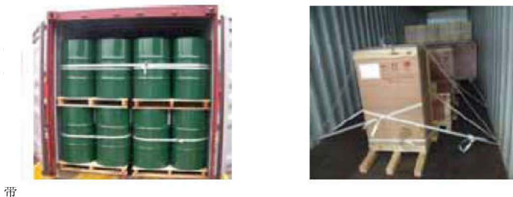
图 J.13 使用紧固带固定的例子
