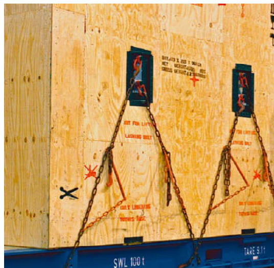
图J.4 使用D环直接紧固的例子
