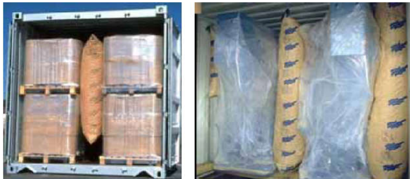
图 J. 14 货物衬垫材料、缓冲材料（分隔材料）的使用例
