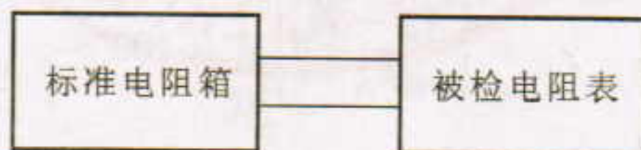
图 11 检定电阻表接线图
