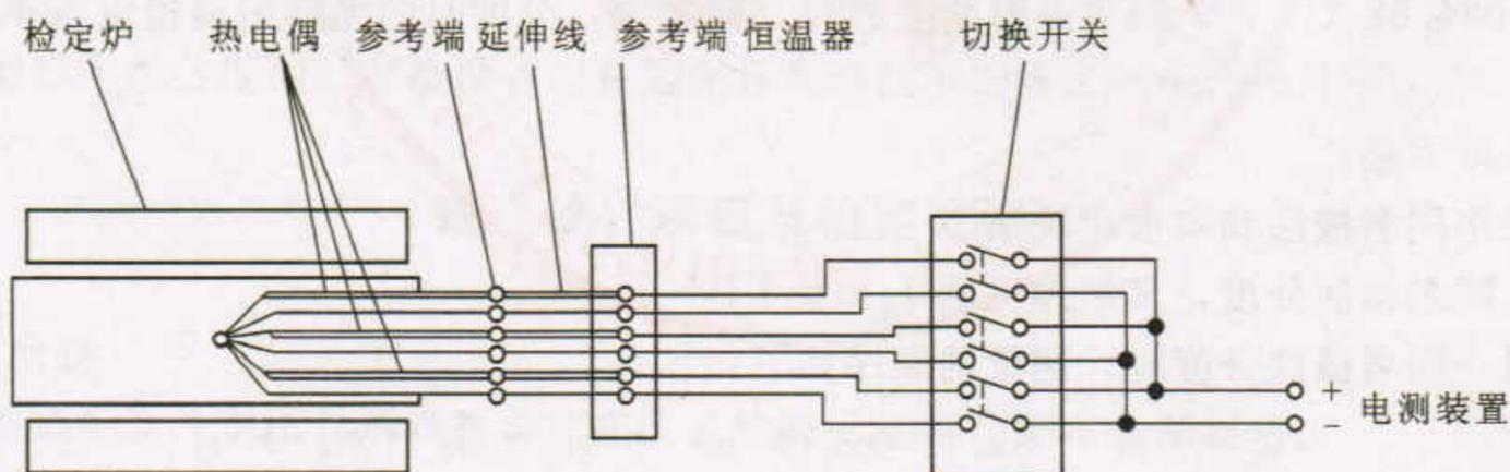
图2 双极法分度原理示意
