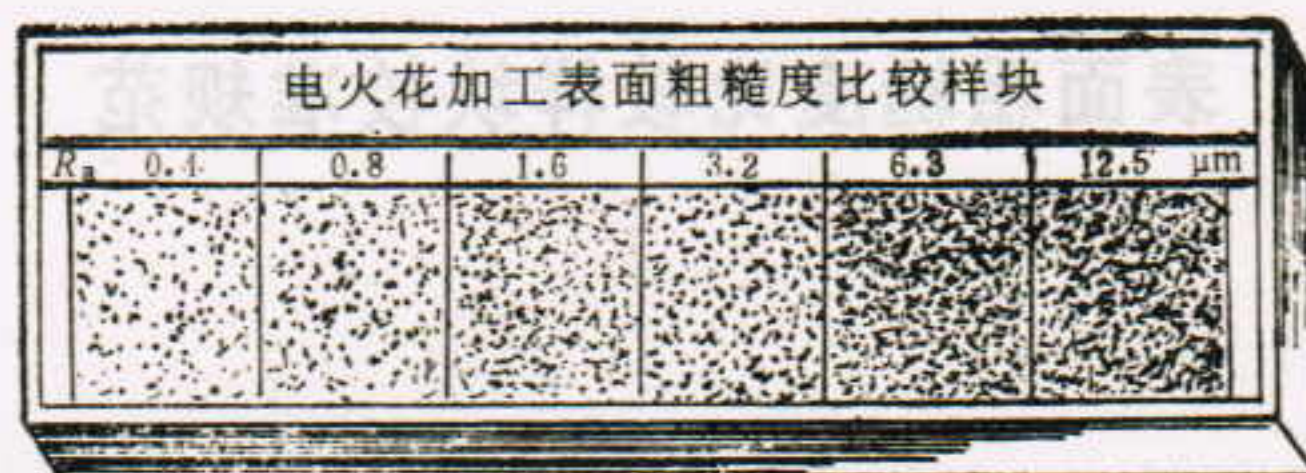
图2 电铸工艺复制的样块
