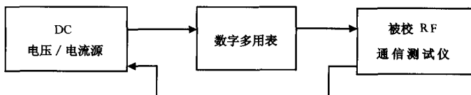
图 20 DC 电流测量误差的测试
