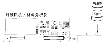
图7 “50Ω 负载”阻抗测量示值的校准
